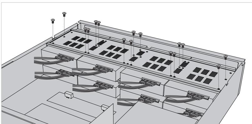
图3-3 安装下层硬盘
