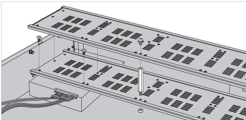
图3-2 安装下层硬盘
